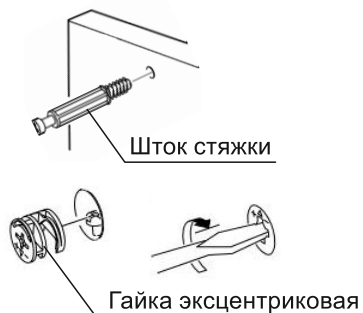
Схема 3. Установка стяжки эксцентриковой
